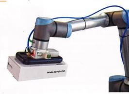
la capacité de levage des cobots ainsi que leur productivité par un montage et un démontage rapides sans outillage spécial. Il intègre une mousse périphérique souple pour protéger l'opérateur, une interface de préhension adaptée à de nombreux matériaux. Il est disponible en trois formats : 150 x 150 mm, 240 x 120 mm et 320 x 160 mm. Générateur de vide, cartouche de pilotage, vacuostat et silencieux sont regroupés dans un bloc fonctions.
