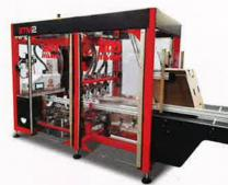
Grâce à son magasin grande capacité, le chargement des découpes s'effectue en continu pour une productivité optimale, jusqu'à 2 500 boîtes formées par heure selon le modèle. La conduite est facilitée par une interface homme/machine intuitive avec assistance au réglage et la connectivité permet la remontée et l'analyse des données de performance.
