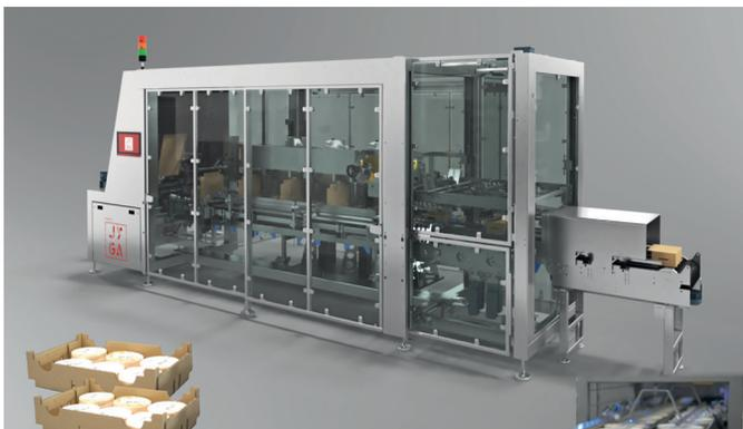
Compacte, l'encaisseuse JB 600 L de Jyga respecte l'intégrité des produits fragiles que sont les fromages, malgré une cadence pouvant monter à 20 caisses/mn.
