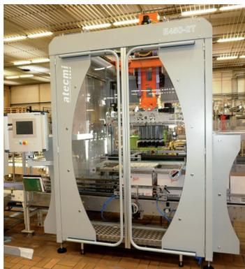
L'encartonneuse E420-2T d'Atecmi est munie d'une tête de préhension à « tulipes » gonflables qui attrape les bouteilles par le col.
