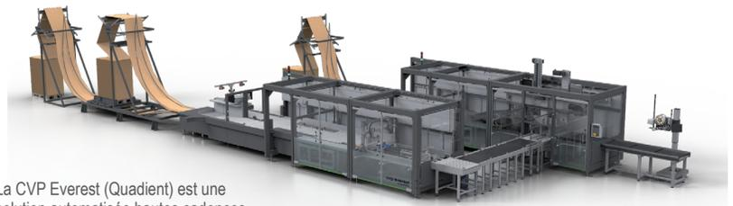
La CVP Everest (Quadiant) est une solution automatisée hautes cadences de réduction du vide dans les 3 dimensions de la caisse et de la coiffe.
