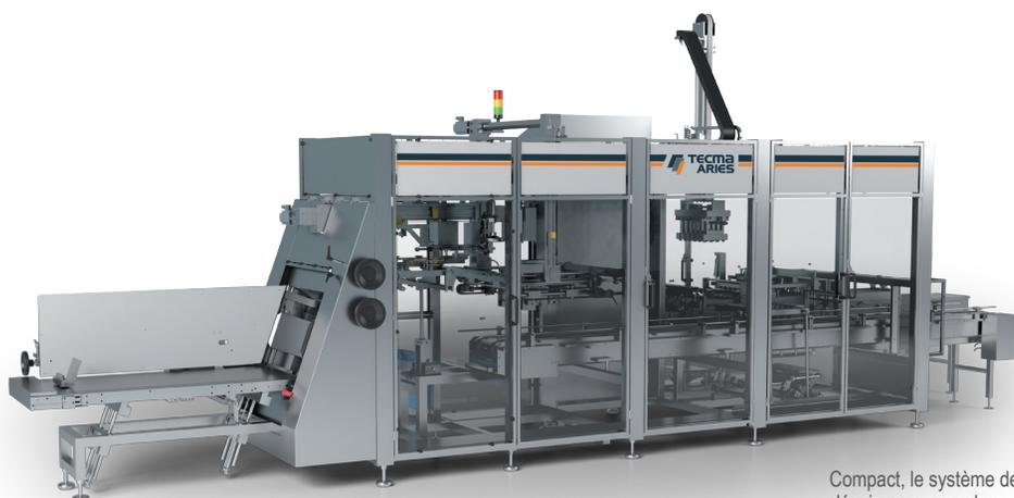
Compact, le système de décaissage-panachage-encaissage-dépose de coiffe de Tecma Aries assure des cadences à 20 barquettes/minute.
