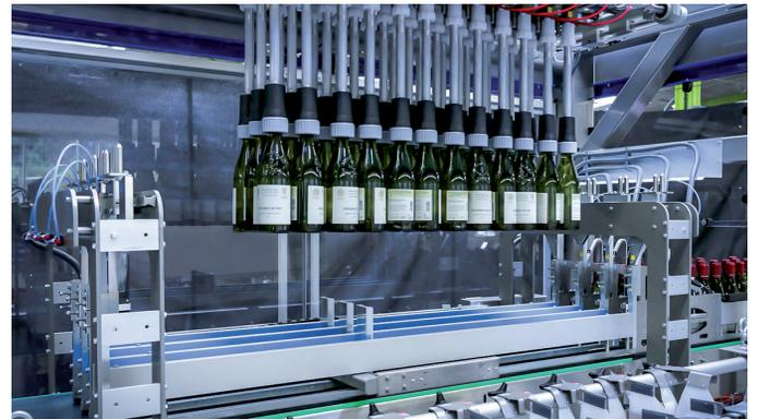
Les ajustements motorisés de l'encaisseuse FlexiPack de Sidel garantissent des changements de format en moins de 10 minutes.
